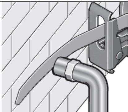
С помощью эластичных биметаллических пильных полотен можно, например, обрезать выступающие элементы (водопроводные трубы и т. п.) заподлицо со стеной. Приставьте пильное полотно прямо к стене и боковым давлением на электроинструмент выгните полотно так, чтобы опорная подошва прилегала к стене. Включите машину и с постоянным боковым давлением отпилите материал.
