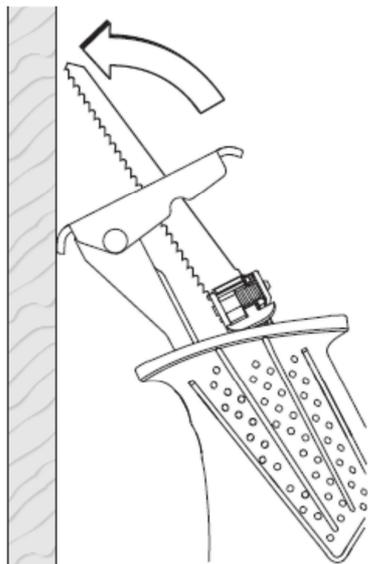
Перед распиливанием древесины, древесностружечных плит, строительных материалов и т.д. проверяйте их на предмет наличия гвоздей, шурупов и т.д. и используйте соответствующее пильное полотно.
